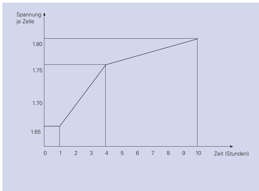
Abbildung 3. Entladeschlussspannung in Abhängigkeit zur Entladedauer
